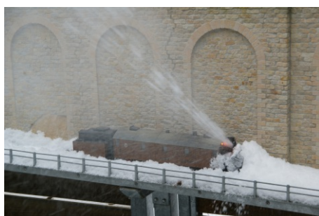
Fréza v plné práci před nádražím Vinohrady
