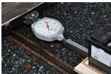
Instalovaný pružinový siloměr
