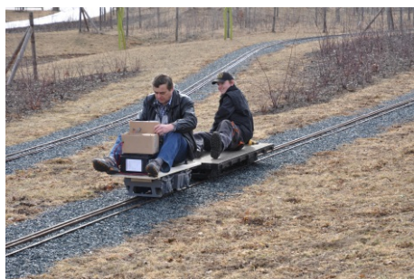
Trakční zkouška jednoho podvozku Tu47 ve výstavbě
